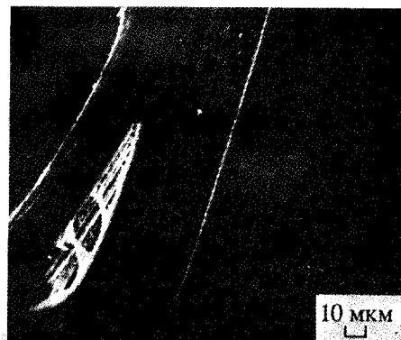
Рис. 4. Электронная микрофотография поверхности и области раздира образца 2.
