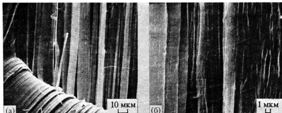
Рис. 2. Электронные микрофотографии картины "лущения" (а) и поверхности лущения (б) образца 1.
