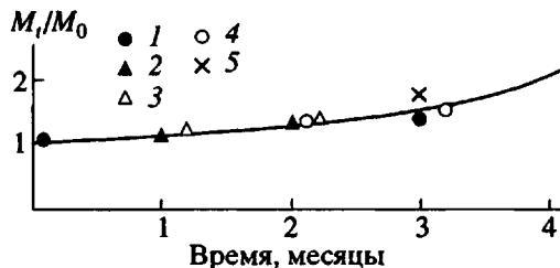
Рис. 3. Зависимость  $M_t/M_0$  от времени старения смолы: 1 — образец 1, 2 — образец 2, 3 — образец 5, 4 — образец 4, 5 — образец 3.
