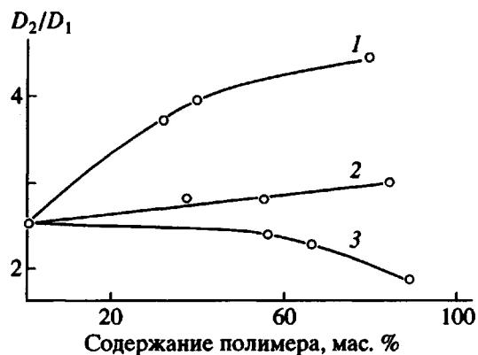
Рис. 2. Зависимость величины  $D_2/D_1$  от состава композиционных пленок. 1 – ПММА, 2 – ПБМА, 3 – ПДМА.
