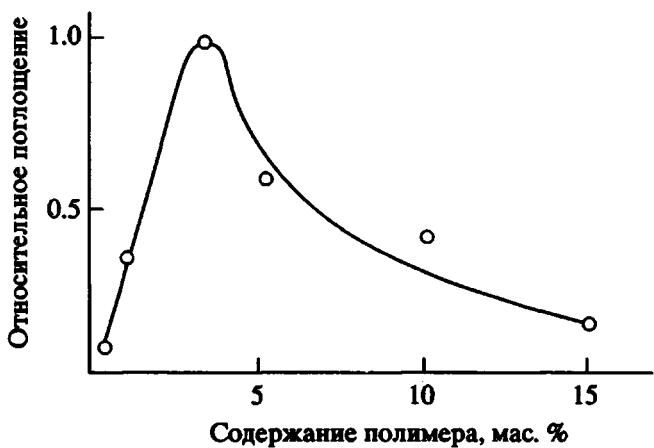
Рис. 9. Зависимость поглощения СВЧ-мощности полимерными композициями от содержания полимера.
