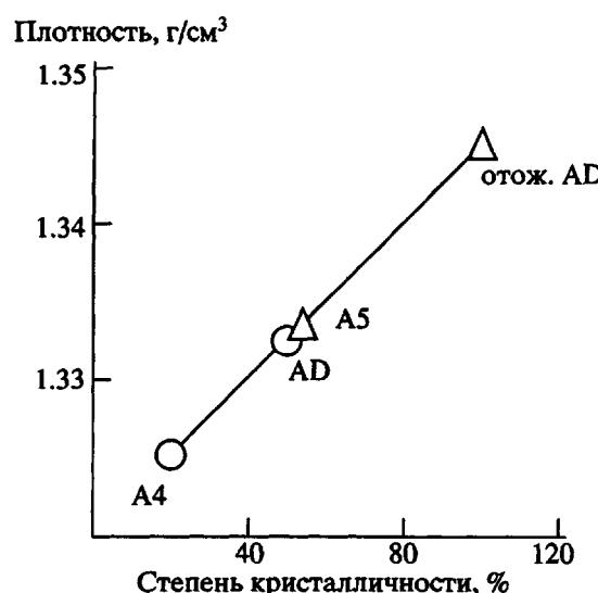
Рис. 1. Корреляция степени кристалличности, оцененной по рентгеноструктурным данным, и плотности, измеренной при 21.7°C. Значения Δ получены экстраполяцией на основе измерений плотности.
