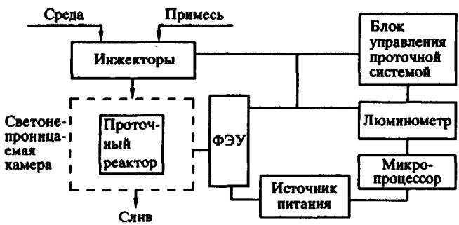
Рис. 14. Блок-схема установки для анализа растворов иммобилизованными ФБ.
