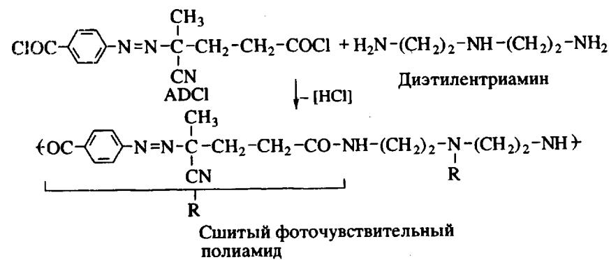
**Рис. 7.** Образование фоточувствительной полиамидной оболочки из ADCl и диэтилентриамина.
