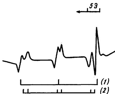
Рис. 2. Спектр ЭПР аддуктов МНП с  $\alpha$ -цианизопронильным радикалом (1) и радикалом роста ЧАС (2) при 35°. Система ЧАС - ДАК - МНП - этанол. [ЧАС]=1,5; [МНП]= $2 \cdot 10^{-3}$  и [ДАК]= $5 \cdot 10^{-2}$  моль/л
