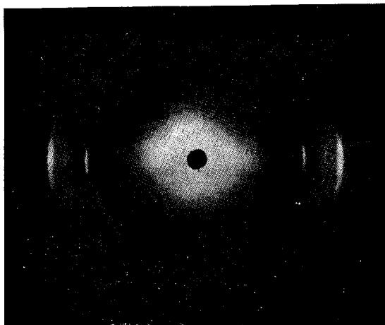
Рис. 4. Рентгенограмма волокна ПБФО, отожженного при 80° в течение 2 ч, снятая при 20°
