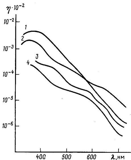
Зависимость квантовой эффективности фотогенерации носителей заряда  $\eta$  от длины волны возбуждающего света.
