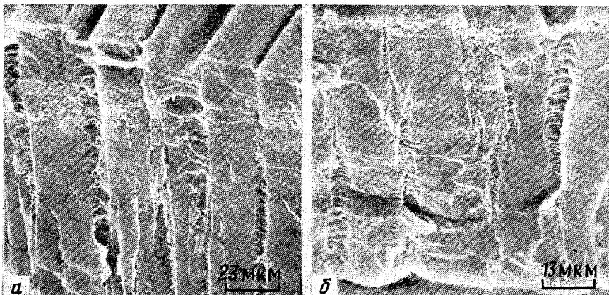
Рис. 2. Электронные микрофотографии пленок ПП, деформированных в *n*-пропаноле на 100% и выдержаных в гептане (а), а также деформированных дополнительно в гептане до 200% (б)
