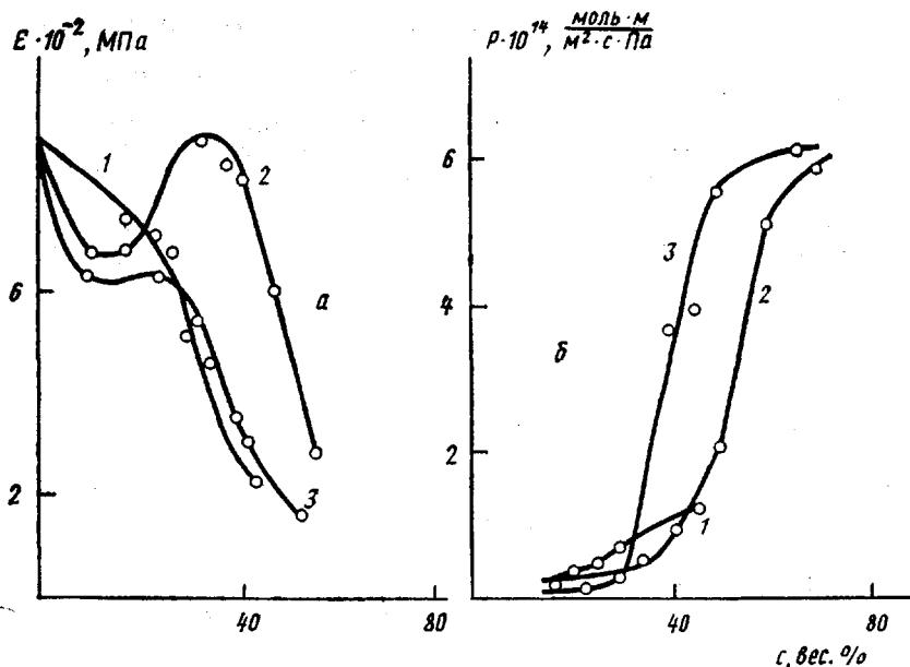
Зависимость модуля упругости  $E_{25^\circ}$  и коэффициента проницаемости по азоту  $P$  от содержания полидиметилсилоxанового блока  $c$  для сополимеров с  $N_c=10$  (1), 20 (2) и 30 (3)
