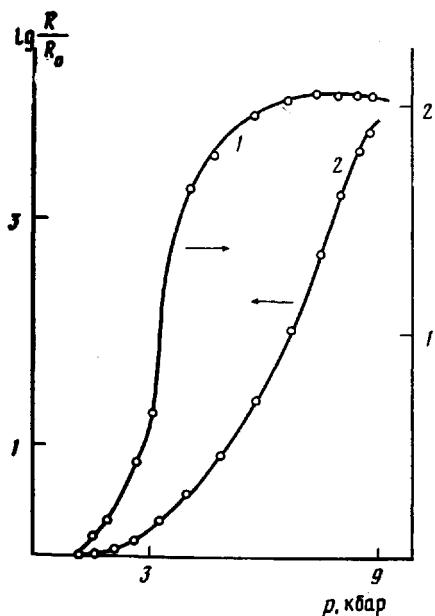
Зависимость относительного электрического сопротивления раствора (1) и растворителя (2) от давления
