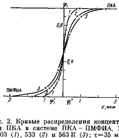
Рис. 2. Кривые распределения концентрации ПКА в системе ПКА - ПМФИА,  $T=503$  (1),  $533$  (2) и  $563$  К (3);  $\tau=35$  мин;  $p=5$  МПа
