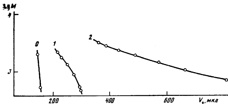
Рис. 3. Калибровочные кривые для олигоарилатов разной функциональности в тройной смеси гексан:хлороформ:изопропанол=47:50:3 (по объему). Цифры у кривых соответствуют функциональности
