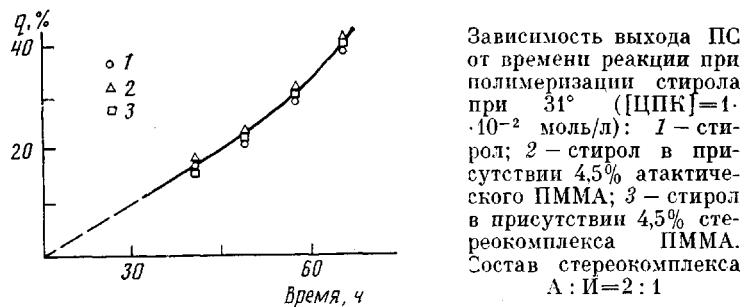
Зависимость выхода ПС от времени реакции при полимеризации стирола при 31° ( $[ЦПК]=1 \cdot 10^{-2}$  моль/л): 1 – стирол; 2 – стирол в присутствии 4,5% атактического ПММА; 3 – стирол в присутствии 4,5% стереокомплекса ПММА. Состав стереокомплекса А : И = 2 : 1
