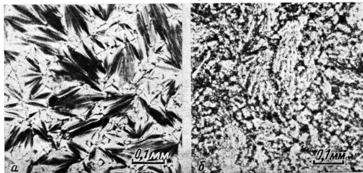
Рис. 1. Оптические текстуры полимера П7М (поляроиды скрещены): *а* – веерная текстура ( $100^\circ$ , фаза  $S_A$ ); *б* – разрушенная веерная текстура ( $65^\circ$ , фаза  $S_F$ )
