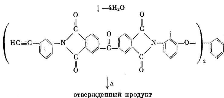
Они являются эффективными связующими для армированных пластиков, способных эксплуатироваться при повышенных температурах.
