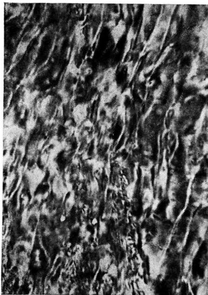
Рис. 1. ЖК-раствор ПАБИ в серной кислоте в оптическом микроскопе при скрещенных поляризаторах ( $\times 50$ )
