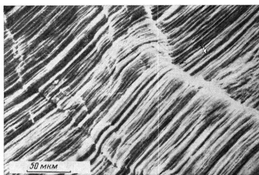
Рис. 6. Следы движения винтовых фронтов полос сброса в ПЭ
