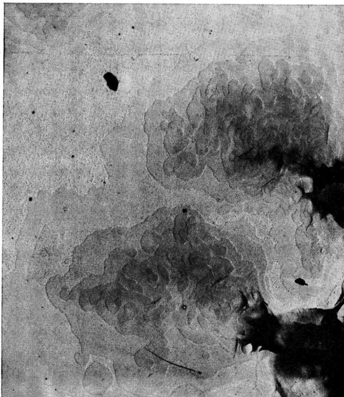
Рис. 8. Морфологические формы полиаллена, образующиеся при полимеризации ( $\times 15\,000$ )
