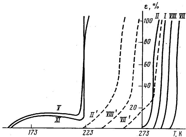
Рис. 2. Термомеханические кривые сополимеров с циклогексасилоксановыми фрагментами в цепи. Постоянно приложенная нагрузка 0,05 МПа, скорость нагревания 5 град/мин. II', VII' и VIII' – соответствующие сополимеры с тетрасилоксановыми циклами между линейными диметилсилоксановыми отрезками [1]. Значения R и n, как в сополимерах II, VII и VIII
