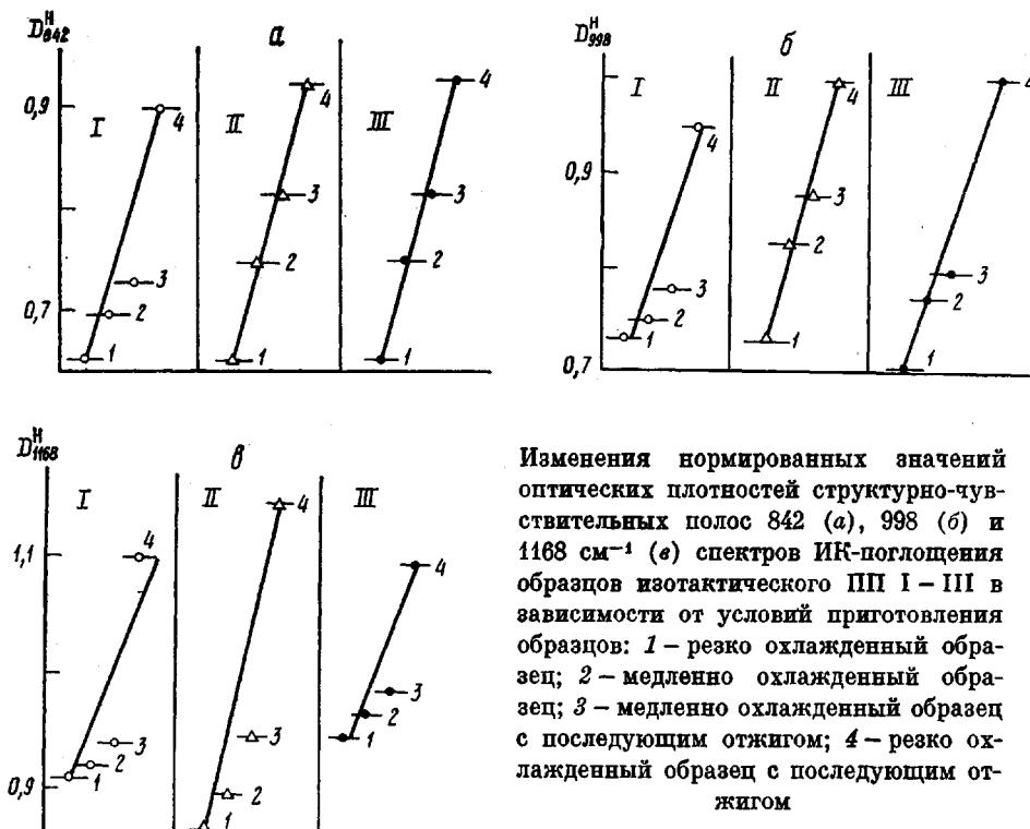
Изменения нормированных значений оптических плотностей структурно-чувствительных полос 842 (а), 998 (б) и 1168 см<sup>-1</sup> (в) спектров ИК-поглощения образцов изотактического ПП I – III в зависимости от условий приготовления образцов: 1 – резко охлажденный образец; 2 – медленно охлажденный образец; 3 – медленно охлажденный образец с последующим отжигом; 4 – резко охлажденный образец с последующим отжигом
