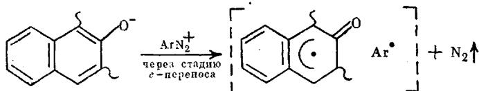
Следовательно, диазорадикал, обладающий очень малым временем жизни (по данным работы [9], время жизни диазорадикала составляет  $\sim 500$  нс), успевает разложиться с выделением азота.
