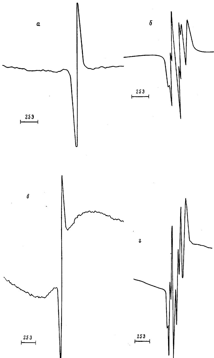
Рис. 1. Спектры ЭПР радикалов, образующихся при взаимодействии НДФА с ненаполненным (*а*, *б*) и наполненным техническим углеродом ПМ-75 (*в*, *г*) резиновым порошком на основе *цис*-1,4-полибутидена: *а*, *в* – спектры исходных образцов резинового порошка (запись при 20°); *б*, *г* – спектры нитроксильных макрорадикалов, образующихся при нагревании резинового порошка с НДФА (запись при 50 (*б*) и 100° (*г*))
