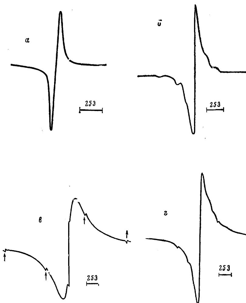
Рис. 2. Спектры ЭПР радикалов, образующихся при взаимодействии НДФА с ненаполненным (*a*, *b*) и наполненным техническим углеродом ПМ-15 (*c*, *d*) резиновым порошком на основе полихлоропрена: *a*, *c* – спектры исходных образцов резинового порошка (запись при 20°); *b*, *d* – спектры макрорадикалов аллильного типа, образующихся при нагревании резинового порошка с НДФА (запись при 80 (*b*) и 120° (*d*)). Стрелками отмечены четыре центральные компоненты шестилинейного спектра  $Mn^{2+}$  в  $MgO$
