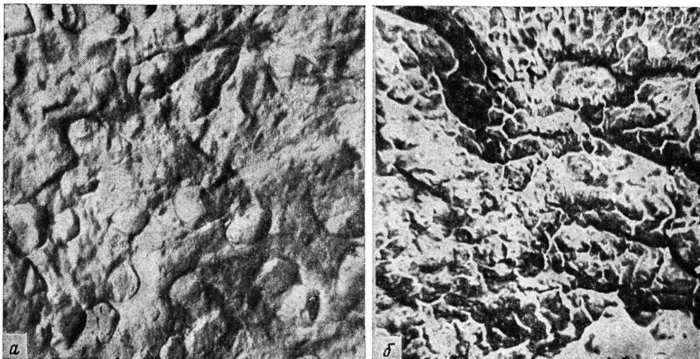
Рис. 2. Электронно-микроскопические фотографии структуры ПУ до термоциклирования (а) и после 43 циклов до 102° (б)
