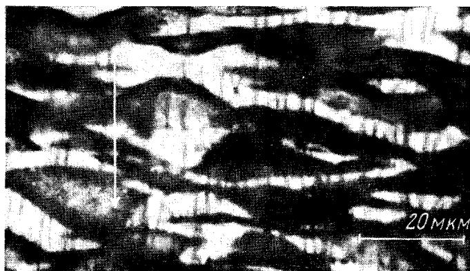
**Рис. 6.** Микрофотографии микротрещин и зон глубокого окисления, образующихся на поверхности толстых отожженных ориентированных образцов ИП при их диффузионном окислении. Стрелкой указано направление оси ориентации
