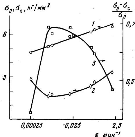
Влияние скорости деформации на величину предела вынужденной эластичности ПЭТФ на воздухе  $\sigma_0$  (1) и в  $n$ -пропаноле  $\sigma_c$  (2) и на эффективность действия жидкой среды  $(\sigma_0 - \sigma_c)/\sigma_0$  (3)
