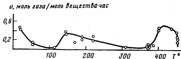
Рис. 4. Скорость термоокисления образцов волокон в зависимости от температуры циклодегидратации
