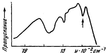
Рис. 2. ИК-спектр порошка  $\gamma$ -окиси алюминия после адсорбции *o*-метилолфенола
