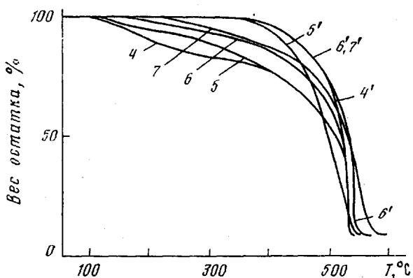
Рис. 4. Термогравиметрические кривые исходных полимеров (4-7) и этих же полимеров, прогретых до 350° (4'-7')
