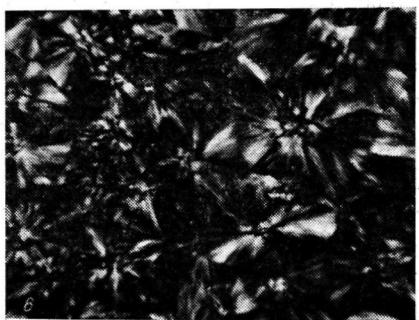
Рис. 4. Оптические микрофотографии привитых сферолитных образцов ПП «Moplen» с различным количеством ПС, отнесенными к массе исходной пленки: 0 (а), 300 (б) и 700% (в)
