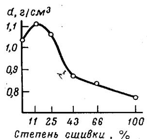
Зависимость кажущейся плотности полимеров, спищих КДХ, от степени сшивки
