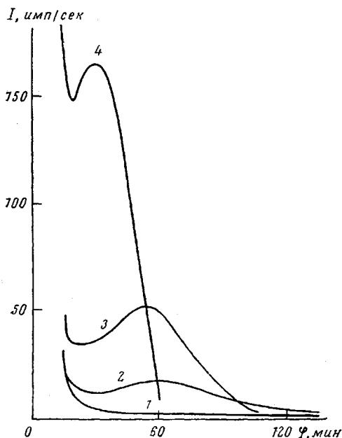
Кривые зависимости малоуглового рассеяния рентгеновых лучей от угла  $\phi=2\theta$  для образца исходного полимера III (1) и образцов после прогревания при 190 (2), 380 (3) и 500° (4)
