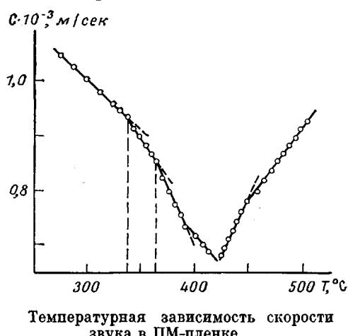
Отметим также, что у ПМ, как это видно из рисунка, наблюдается двойной переход (при  $340$  и  $370^\circ$ ) в области стеклования, что хорошо согласуется с обнаруженным в [19] наличием у аморфных полимеров двух температурных переходов в главной релаксационной области, обусловленных двумя уровнями надмолекулярной организации.
