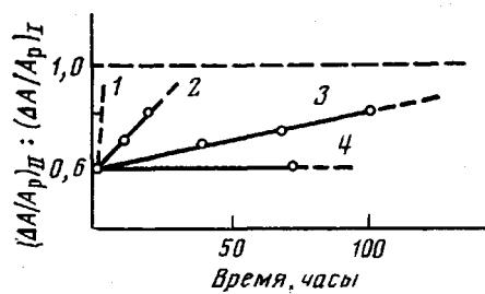
Рис. 5. Восстановление исходных механических свойств соллпрена-406 после размягчения при  $100$  (1),  $50$  (2),  $20$  (3) и  $-5^\circ$  (4)
