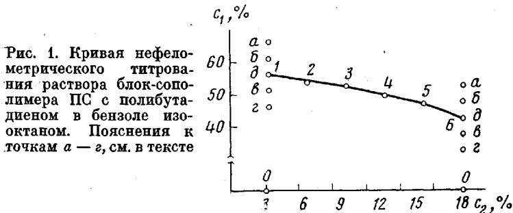
Рис. 1. Кривая нефелометрического титрования раствора блок-сополимера ПС с полибутадиеном в бензоле изооктаном. Пояснения к точкам  $a$  —  $g$ , см. в тексте
