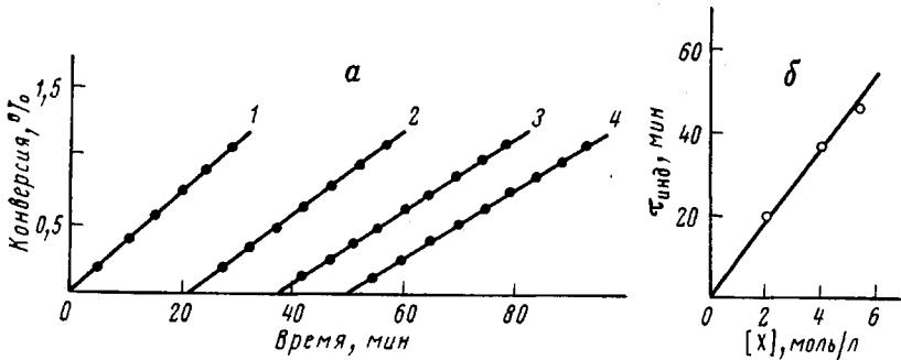
а — Кинетика полимеризации МАКЛ в присутствии ингибитора ( $[ДАК] = 2,5 \cdot 10^{-3}$ ;  $[M] = 0,86$  моль/л;  $40^\circ$ );  $[X] \cdot 10^4 = 0$  (1),  $1,4$  (2),  $3,8$  (3),  $5,7$  моль/л (4); б — зависимость индукционного периода от концентрации ингибитора
