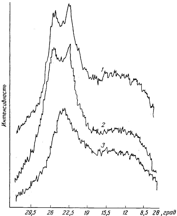
Рис. 3. Рентгенограммы пленок ОЭПА (обозначения кривых см. рис. 1)
