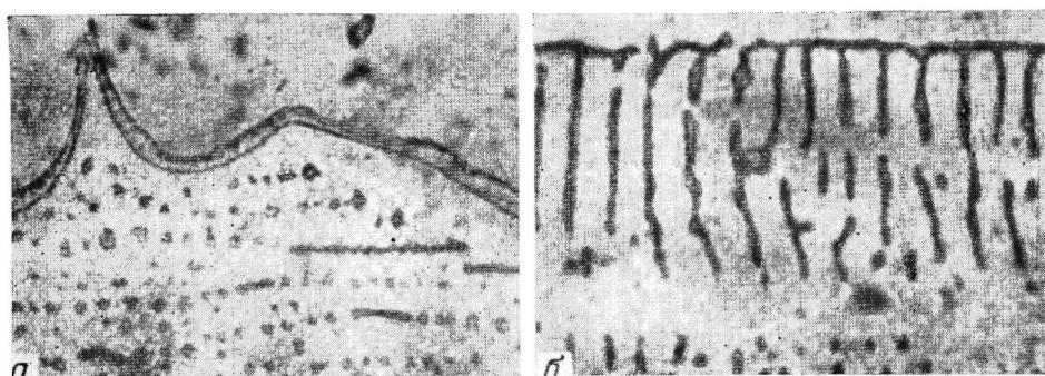
Фотографии микродефектов, сформировавшихся в пленках со сложной формой края (а) и при условиях, когда ровная граница края пленки находилась под углом 90° к направлению действия электрического поля (б)
