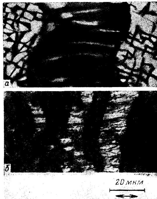
Рис. 3. Микрофотографии структуры деформированных пленочных образцов ПХП (а) и образцов ПУ, изготовленных в прессе, (б) на промежуточной стадии деформирования (стрелкой указано направление деформирования)
