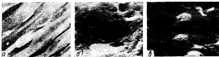
Рис. 4. Микрофотографии поверхности разрушения эпоксидной смолы, отверженной ЭДА (а), модифицированной СТВН и отверженной ГМДА (б) и ДМР-30 (в)
