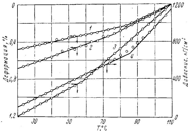
Рис. 3. Зависимость деформации теплового расширения при различных давлениях (1—3) и давления (4) от температуры при постоянном объеме;  $p=2500$  (1),  $1250$  (2) и  $1 \text{ кг}/\text{см}^2$  (3)
