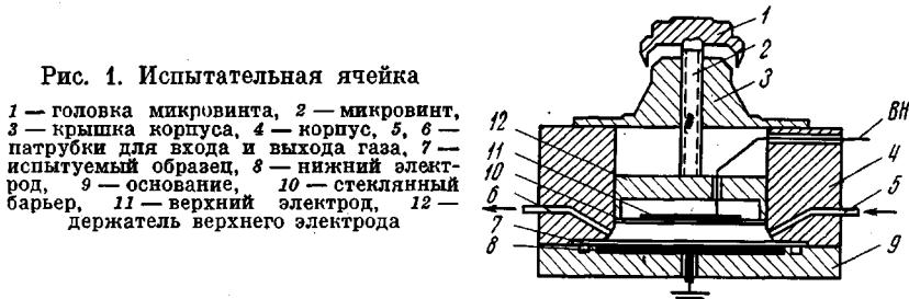
Рис. 1. Испытательная ячейка
