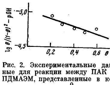
Рис. 2. Экспериментальные данные для реакции между ПАК и ПДМАЭМ, представленные в координатах  $\lg \frac{\theta}{(1-\theta)^2} - \text{pOH}$  от  $\theta$
