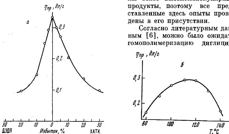
Рис. 1. Зависимость приведенной вязкости полиэфира на основе ДЭДП от избытка исходных реагентов (а) и от температуры реакции (б):
