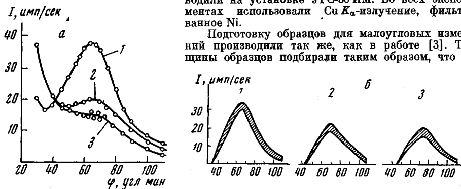
Рис. 2. Кривые распределения малоуглового рассеяния рентгеновых лучей на волокнах из ПА-6 (а) и после отделения диффузного рассеяния и приведения к одинаковому количеству ПА-6 (б) при \psi = 0 (1); 73 (2) и 160% (3)
