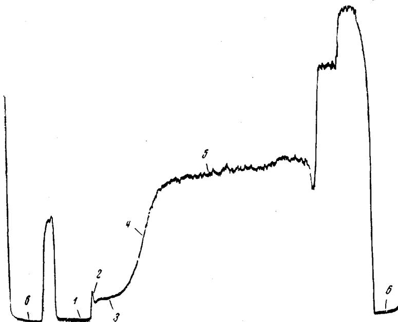
Рис. 2. Фотометрограмма раствора образца блок-сополимера в смеси октан : циклогексан = 3 : 1 ( $c = 0,1 \text{ г}/100 \text{ см}^3$ ); цифрами обозначены участки поглощения, соответствующие воздуху в кювете (1); мениску (2); чистому растворителю (3); границе растворитель — раствор (4); раствору (плато) (5); реперным отверстиям противовеса (6)
