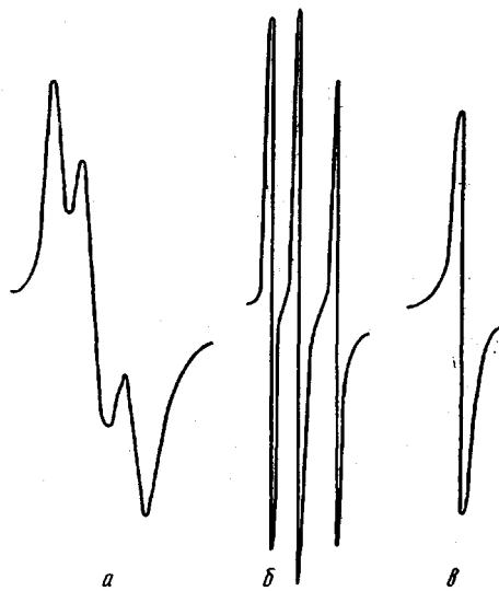
Рис. 7. Спектры ЭПР 2,2',6,6'-тетраметилпиперидин-1-оксила в растворе бензола (a); в смектическом (b) и кристаллическом состояниях (c) при 20°
