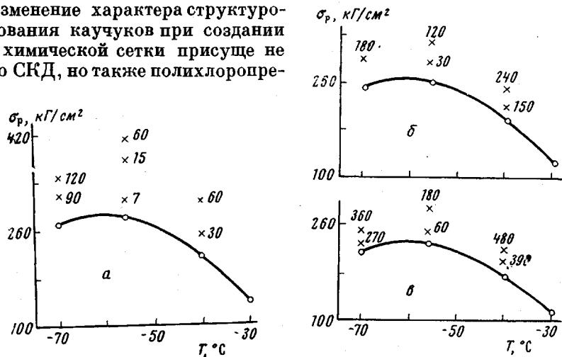
Рис. 2. Температурно-временная зависимость условной прочности вулканизатов СКД.  $M \cdot 10^{-3} = 4,8$  (а); 3,8 (б) и 3,4 (в)
